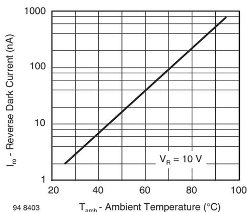
図 1 - 逆方向暗電流 VS. 周囲温度
