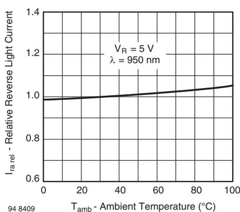
図 2 - 相対逆方向光電流 VS. 周囲温度
